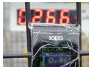
毎時0.266 \mu Svと表示されていますが、別の放射線測定器で計測すると毎時0.46 \mu Svありました。このように、設置されている放射線測定器では実際の空間放射線量率よりも低めに表示されている事が、私たちの調査で明らかになっています。(富岡駅前/2015年10月)
