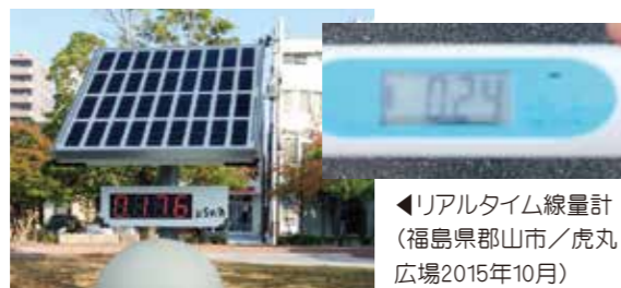
リアルタイム線量計では毎時0.176 \mu Svと表示されていますが、同じ場所で別の放射線測定器で計測すると毎時0.24 \mu Svありました。
